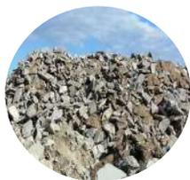
**AGGREGATI ARTIFICIALI E RICICLATI AL POSTO DI MATERIALI DA CAVA.** Oggi è possibile utilizzare gli aggregati di materiali provenienti dai rifiuti di C&D con vantaggi notevoli, perché si riduce l'utilizzo di materiale proveniente da cava.
